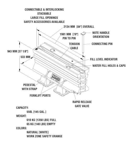
Figure 2 Triton Barrier<sup>®</sup> TL-3 Components
