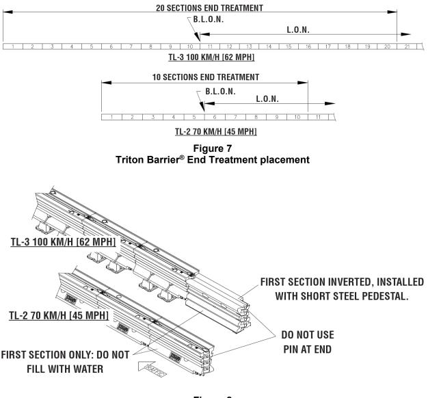
Figure 8 Triton Barrier<sup>®</sup> End Treatment
