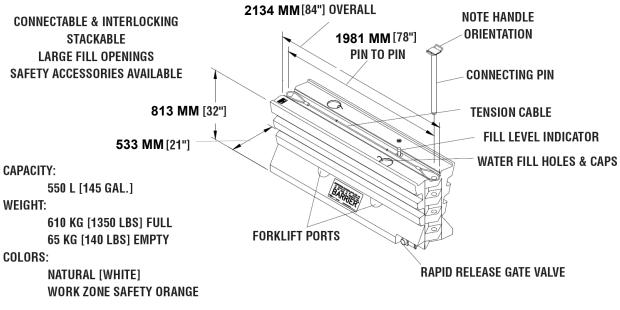
Figure 1 Triton Barrier<sup>®</sup> TL-2 Components
