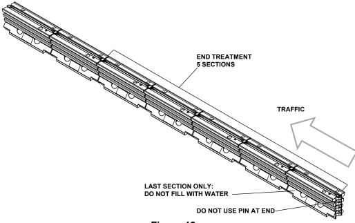
Figure 19 Triton Barrier<sup>®</sup> TL-1 End Treatment
